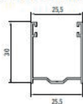
ART. GU27 Guida in alluminio A27 25,5 X 30 mm
